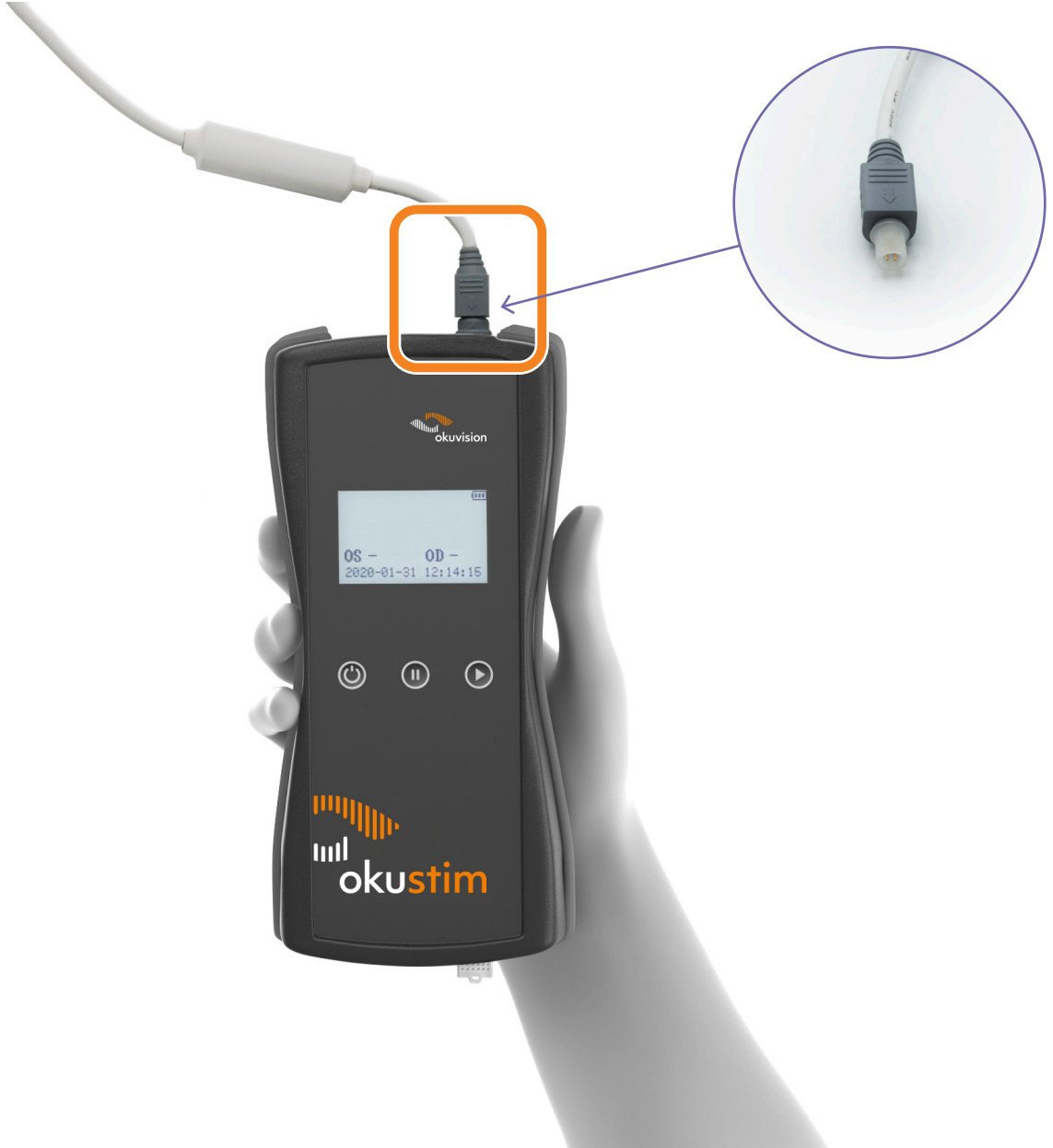
شكل 6-5: قابس نظارة OkuSpex بجهاز OkuStim
