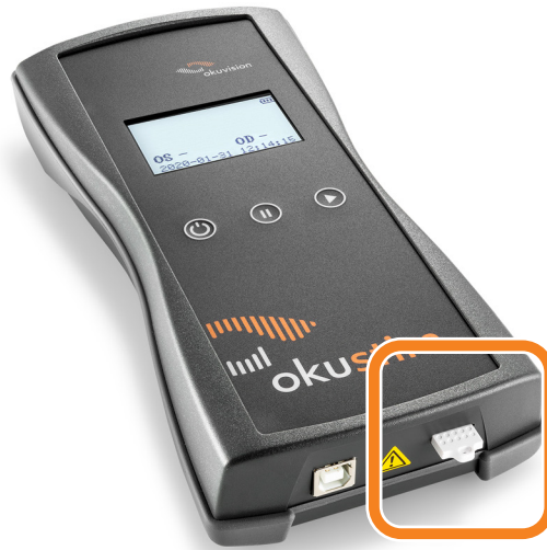
الشكل 3-1: الجانب الأبيض لبطاقة ذاكرة USB يجب أن يشير إلى أعلى عند تركيبها في جهاز OkuStim.
