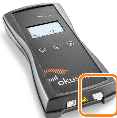
Kuva 3-1: USB-tikun valkoisen puolen on oltava ylöspäin, kun se työnnetään OkuStimin sisään.
